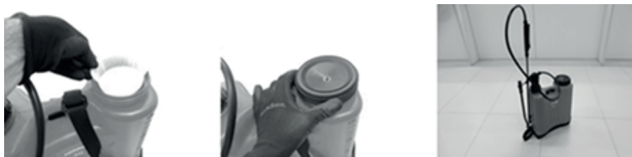
Fig. 11 – Verificação e instalação da peneira
