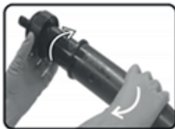
Fig. 16 – Liberando a câmara de compressão do cilindro
