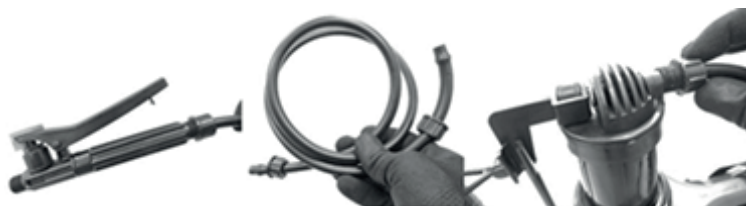
Fig. 8 – Instalação da mangueira
