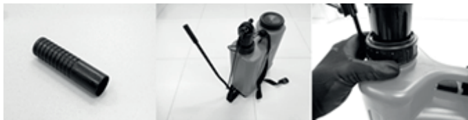
Fig. 7 – Manopla de alavanca de acionamento e aperto de porca do sistema de compressão
