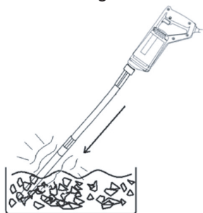
Figura 9: Mangote sendo mergulhado no concreto.
