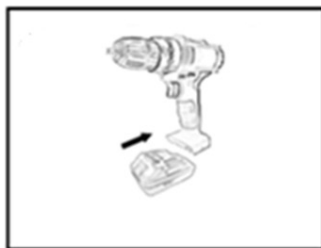
ENCAIXE A BATERIA DE LÍTIO NA BASE DA PARAFUSADEIRA
