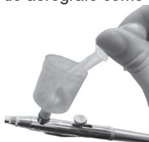
Figura 08: Colocando tinta com tubo dosador
