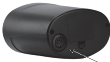
Figura 5: Local de encaixe do plugue do fio da bobina (8) na caixa de controle (3).
