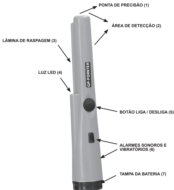
Figura 1: Principais componentes do detector de metais.
