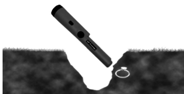
Figura 4: Exemplo de objeto metálico encontrado com o TRATO TDET20.
