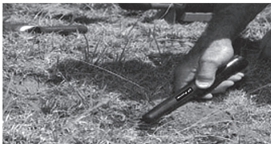
Figura 5: Raspagem do solo enquanto é realizada a varredura lateral.
